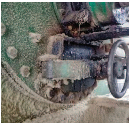
Фото 1. Жидкость, вытекающая из выгрузного клапана котла, — одна из причин перезаражения технологического оборудования и готовой продукции
