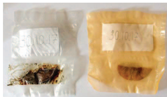
Опытные образцы: слева — пакет из обычной пленки, справа — пакет из полимера Силостоп®
