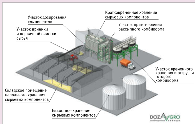
Схема расположения участков завода по производству рассыпного комбикорма производительностью 6 т/ч
