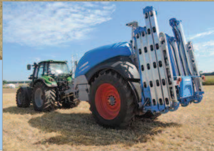
При помощи гидравлики Vega 12 раскладывается в ширину
